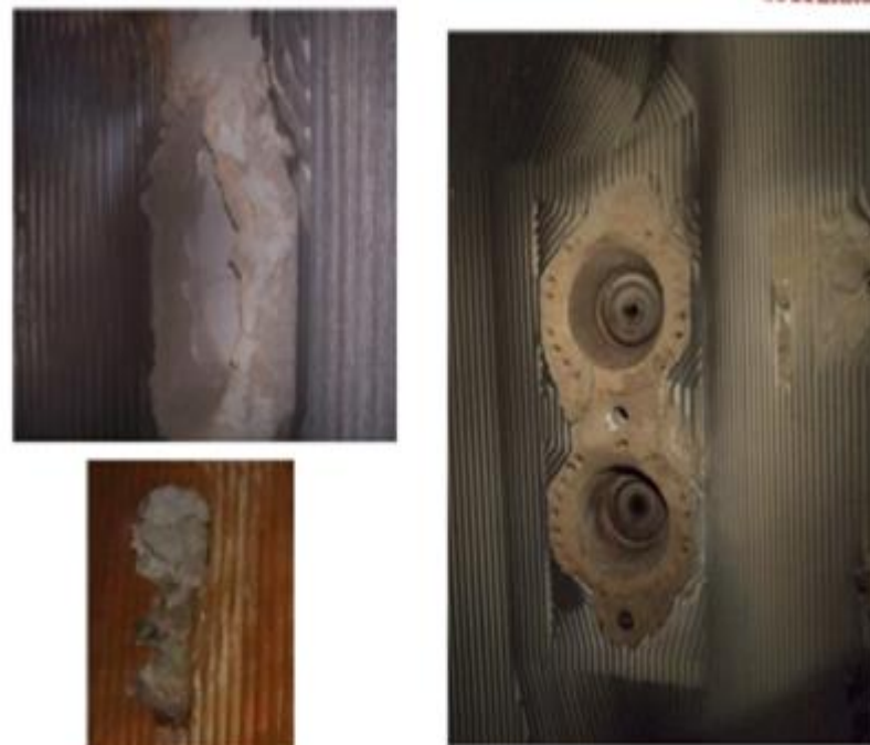
Widok palnika i dysz dodatków po testach w kotle K-10 (ESW) A/ kaolin – 4 tygodnie B/ haloizyt Dunino– 6 tygodni
